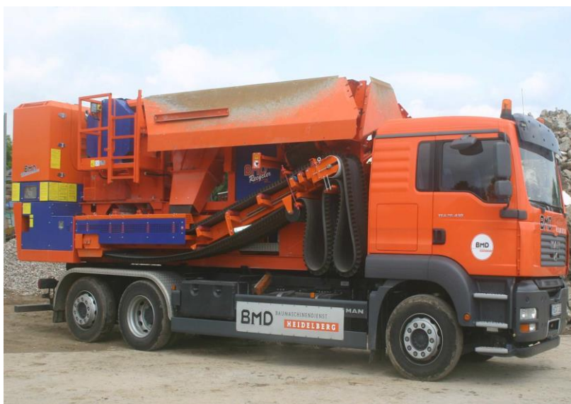
Usina móvel de Reciclagem de Resíduos da Construção Civil BMD 700/6
